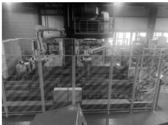
图 11 钢丝圈存储及自动装卸实物照
