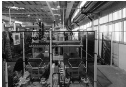
图6 钢圈槽车 / 钢圈自动供给装置实物图
