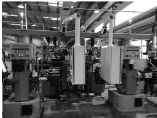
图5 机械鼓式立式贴合站实物图
