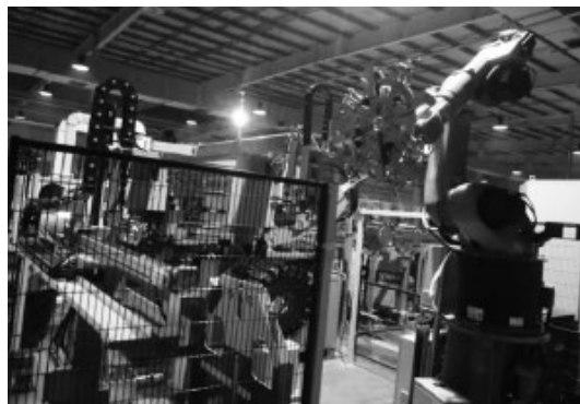
图7 胎圈抓取夹具 / 成品自动卸载码垛实物图
